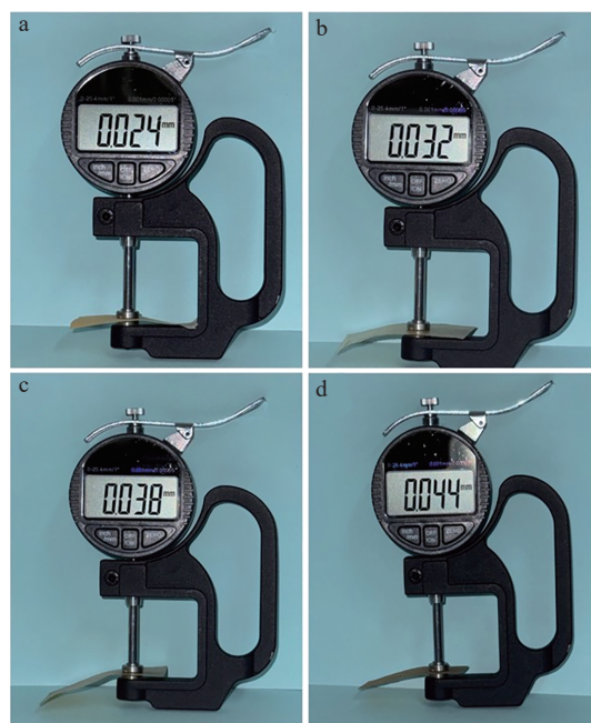
图7 不同质量分数PBI的纳米纤维膜厚度:(a) 6% PBI; (b) 8% PBI; (c) 10% PBI; (d) 12% PBI
