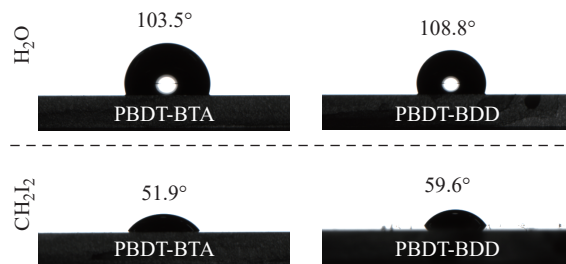
图8 聚合物PBDT-BTA和PBDT-BDD薄膜表面 \text{H}_2\text{O} 和 \text{CH}_2\text{I}_2 的接触角图像
