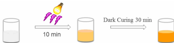
图 25 乙酰丙酮铂光催化硅氢加成反应及暗固化过程
