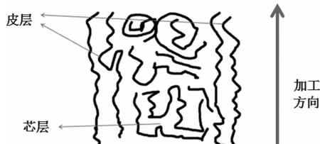
图 2 双酚 A 型聚碳酸酯(PC)/液晶聚酯(LCP)复合材料的皮-芯结构示意图,其中皮层中 LCP 的浓度与沿加工方向的微纤化程度(或长径比)均高于芯层
