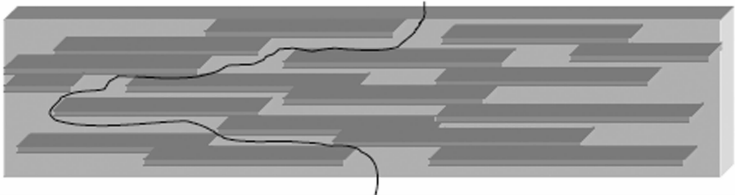
图 9 纳米片层改性聚合物薄膜后的气体透过路径 [60]
