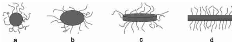
图 5 纳米胶束的形态变化 (a)球形 (b)扁平状 (c)盘状 (d)棒状
