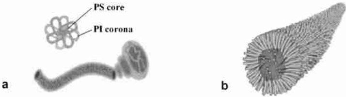
图 9 环状 PS- b -PI 共聚物和(b)PEO- b -PEE 及 PEO- b -PB 共聚物自组装形成线状胶束示意图
