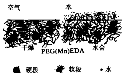
图 5 具有亲水性软段聚氨酯表面的环境响应
