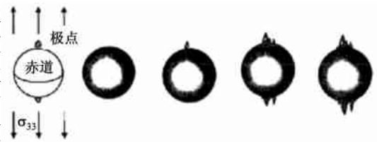
图 3 嵌在橡胶基体中的刚性粒子两极的空化过程 [9]
