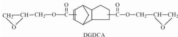
图 5 双环戊二烯双环氧化合物 DGDCA 的结构图
