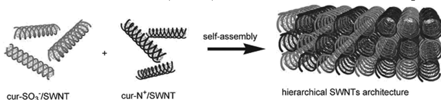
图 4 SWNTs/改性 \beta -1,3-葡聚糖复合物自主装示意图 [29]
