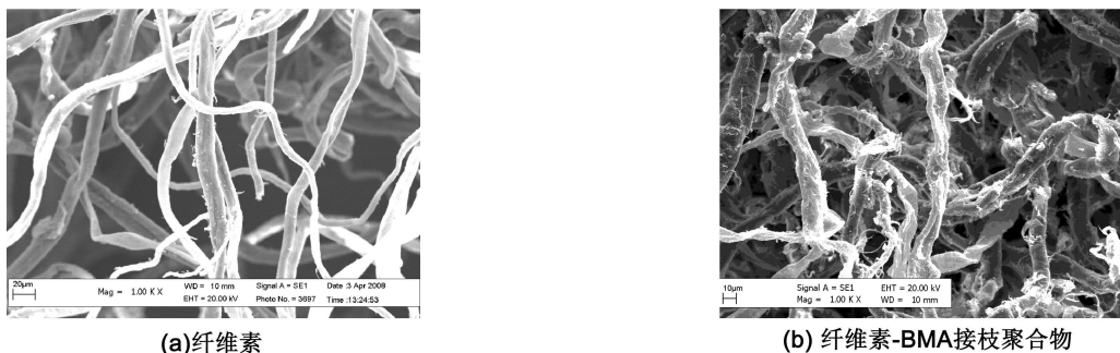
图 11 纤维素及纤维素-BMA 接枝聚合物的扫描电镜图 ( \times 1000 )
