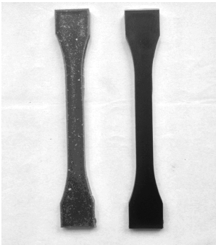
图 5 PP/WPCB(30%)复合材料外观(左)未磨(右)碾磨 30 次
