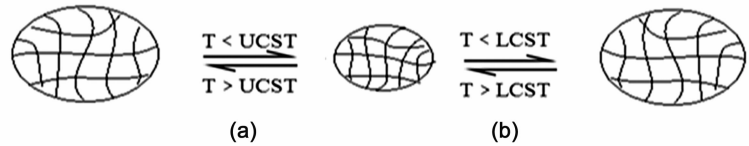
图 1 热胀(a)和热缩(b)型温敏水凝胶的溶胀、去溶胀示意图
