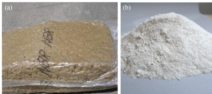
图 5 丁腈橡胶的外观性状:(a)块状,(b)粉末
